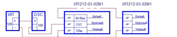
Подключение внешнего ОЗС к ИП212-03-02М1 (ИП – источник питания для ОЗС).
