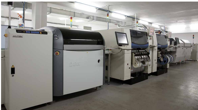
Автоматическая линия SMD монтажа
