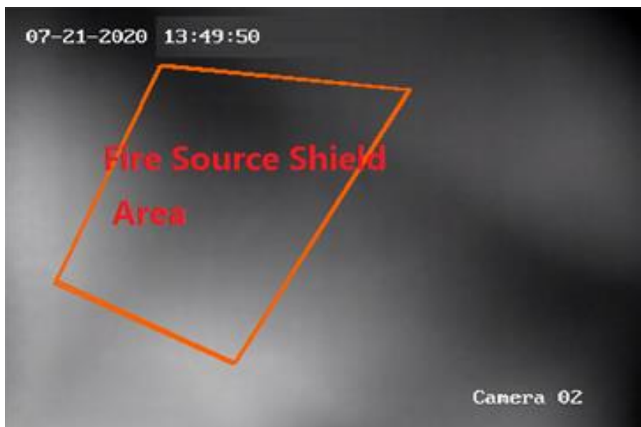
Рисунок 5-10 Маскирование области от обнаружения источника огня
