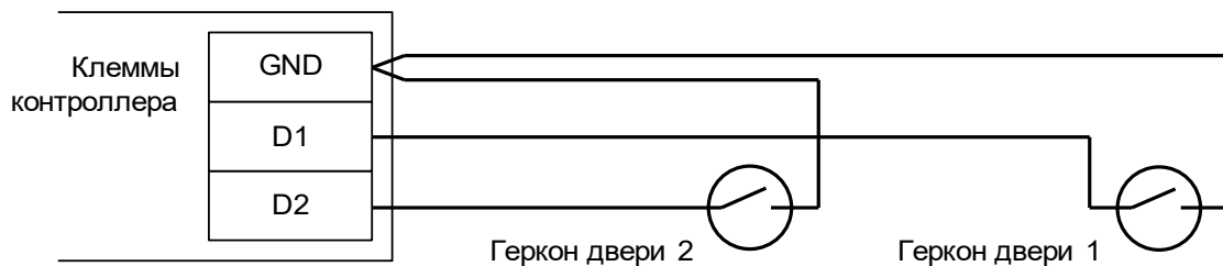
Рисунок 38. Подключение датчиков открытия дверей.
