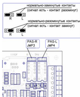
Рисунок 94. Перемычки JMP3 и JMP4 контроллера OMA 264MC1.
