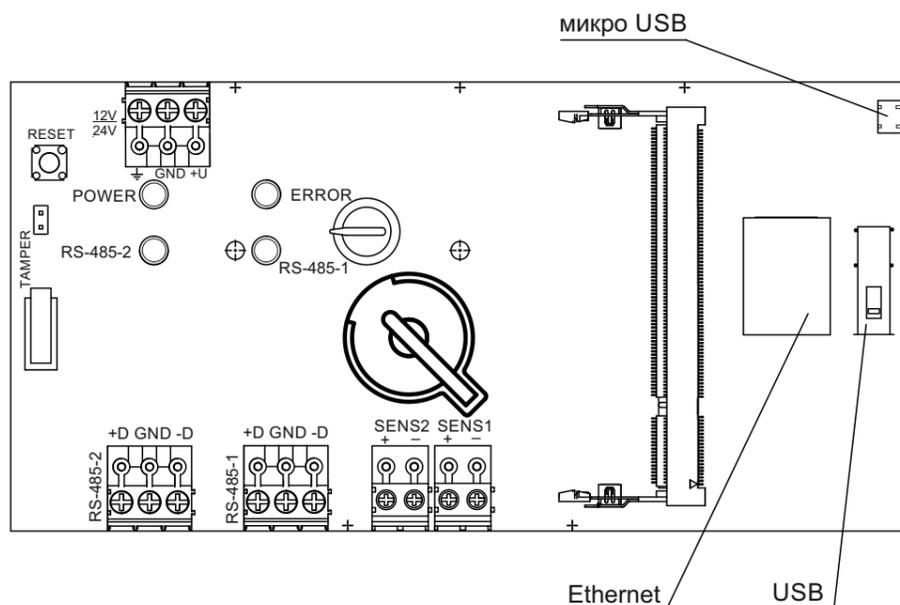
Рисунок 2 – Плата контроллера доступа
