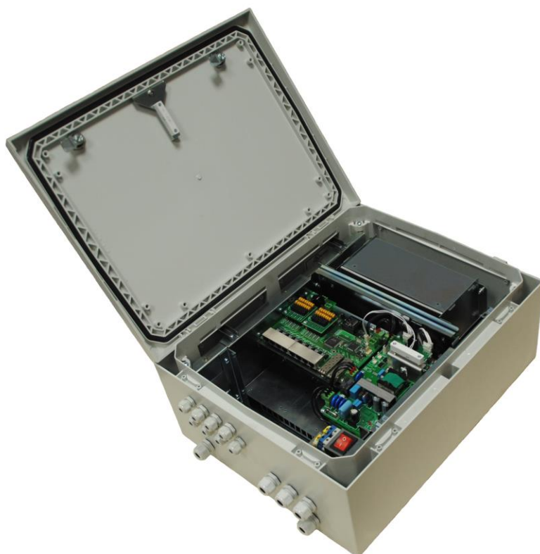
Рисунок 3.1.2 - PSW-2G8F+UPS-Box - вид внутри
