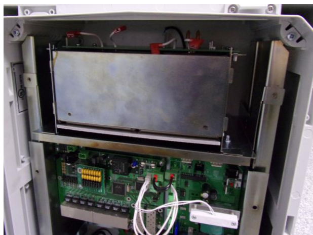
Рисунок 7.1 – Демонтаж АКБ отсека
