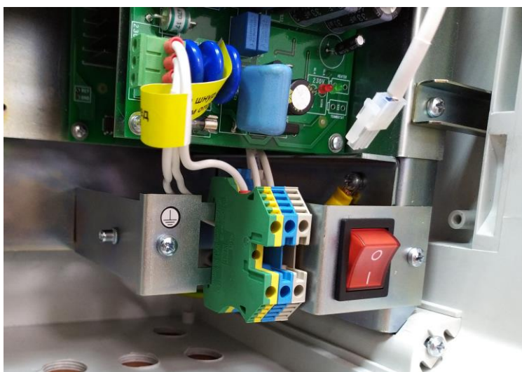
Рисунок 3.5.1 – Узел подключения питания.
