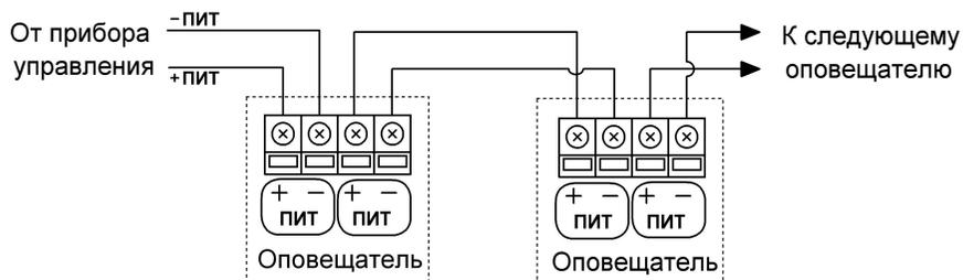
Рис.2 - Схема подключения «АСТО12-КМ-1(2)», «АСТО12/1-КМ-1(2)».
