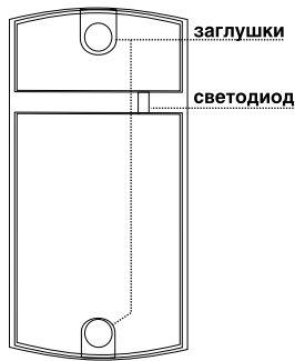
Рис.2 Внешний вид и вид платы считывателя
