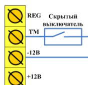
Рисунок 4.3 – Схема подключения скрытого выключателя или кнопки
