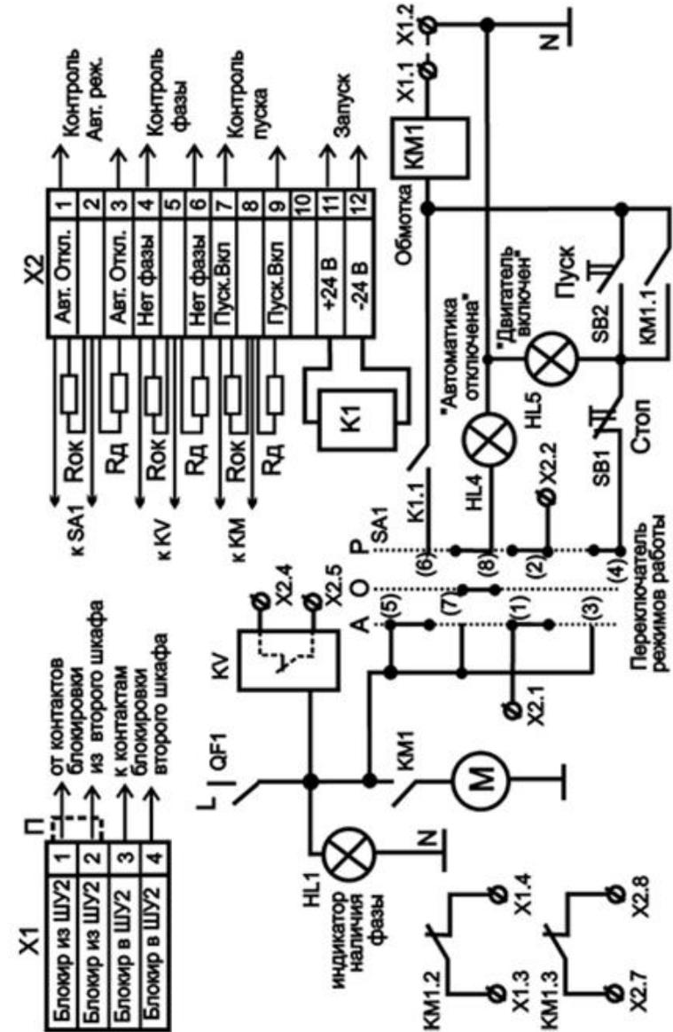
Рис. 2 - Схема ШУ с рабочим напряжением 220 В
