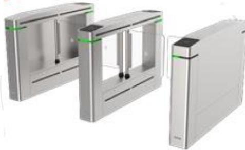
Турникет DS-K3B601SX является распашным турникетом с 12 парами датчиков с ИК-подсветкой. Предназначен для детекции несанкционированного входа или выхода. Турникет интегрирован в систему контроля доступа, аутентификация при входе реализована при помощи IC- или ID-карты, сканирования QR-код и т. д. Турникеты широко используются в парках аттракционов, на стадионах, строительных площадках, в жилых домах и др.
