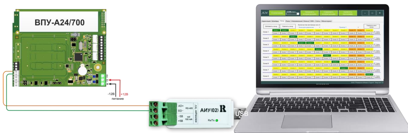
Рисунок 93. Схема подключения для конфигурирования ВПУ-А24/700
