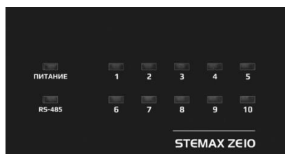
Рисунок 6.2 – Лицевая панель STEMAX ZE10
