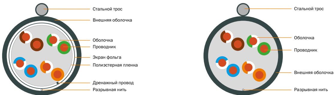
Вид кабеля в поперечном разрезе
