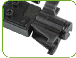
Тип разъемов выбирается поворотом упорного держателя на 180°
