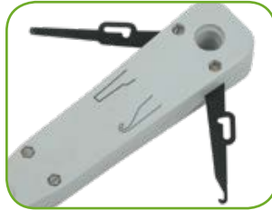
Плоская отвертка и крючок для укладки жил
