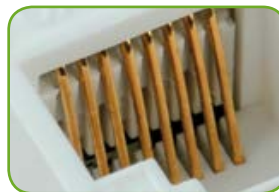
Высокое качество модульных контактов
