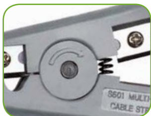
Регулирование глубины надреза
