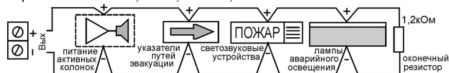
Рис. 2 – Схема подключения нагрузок к выходам «Вых.1», «Вых.2»
