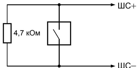
Включение кнопки ВЫХОД и датчика открывания двери в ШС1 при использовании контроля доступа. Тип ШС1 - 4 ("Охранный") или 7 ("Охранный входной")
