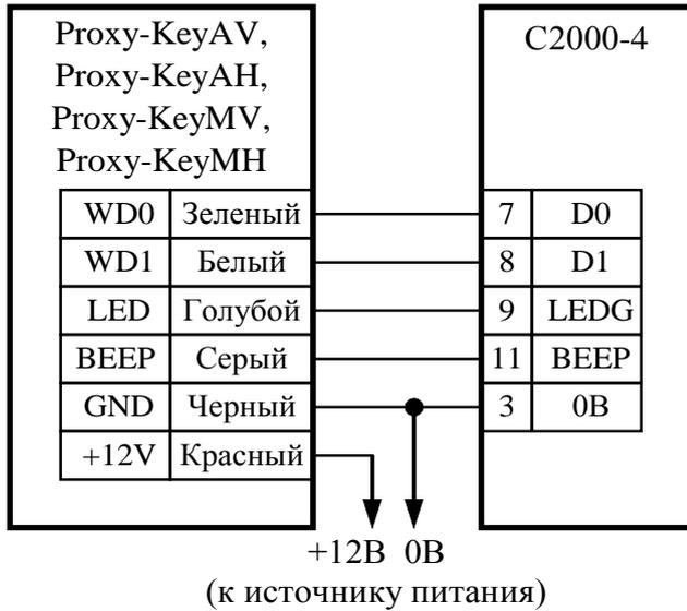
Считыватель используется для взятия/снятия
