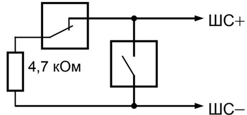
Включение охранных извещателей с блокировочными контактами в ШС типа 5 ("Охранный с контролем блокировки")
