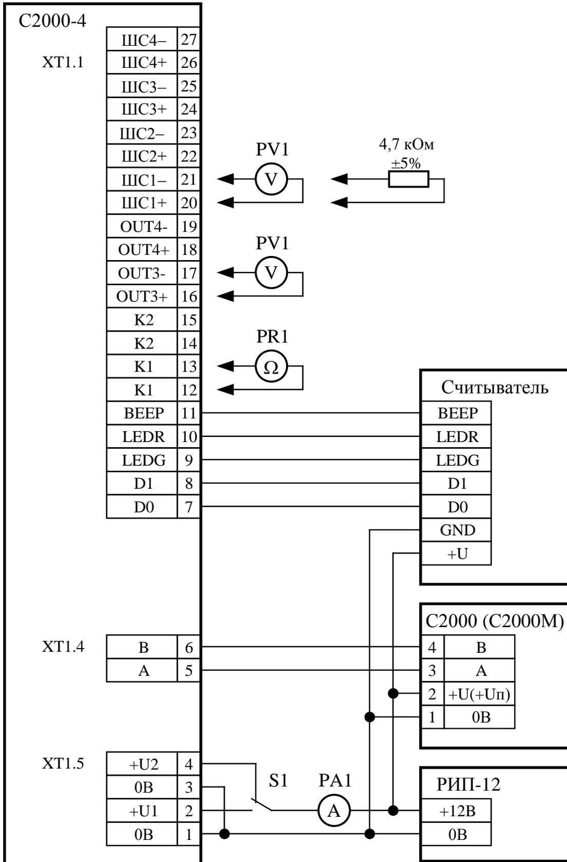
**PV1, PR1, PA1** – прибор комбинированный (тестер) в режиме измерения напряжения, сопротивления и тока соответственно
