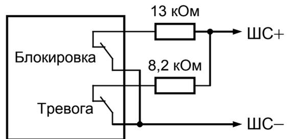
Включение датчиков протечки жидкости в ШС типа 17 ("Водосигнальный")
