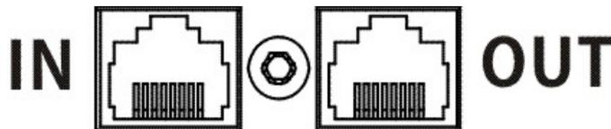
Порт для подключения функции защиты от перенапряжений сети/телефона/модема
