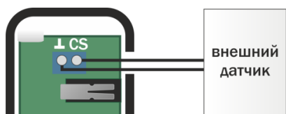
Рисунок 5.5 – Схема подключения внешнего проводного датчика открытия
