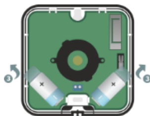
Рисунок 4.23 – Снятие защитных пленок с батарей сирены
